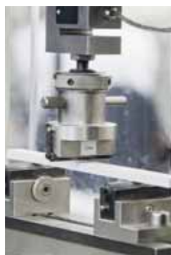
ПРОЧНОСТЬ НА ИЗГИБ МАТЕРИАЛА SAPHIRKERAMIK В 2 РАЗА ВЫШЕ ПРОЧНОСТИ ИЗДЕЛИЙ ИЗ ТРАДИЦИОННЫХ МАТЕРИАЛОВ
