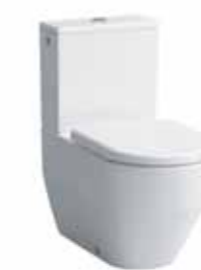
Напольный унитаз, комбинированный, оптимизирован 4.5/3л / 6/3л, безободковый смыв Rimless, выпуск горизонтальный/вертикальный
